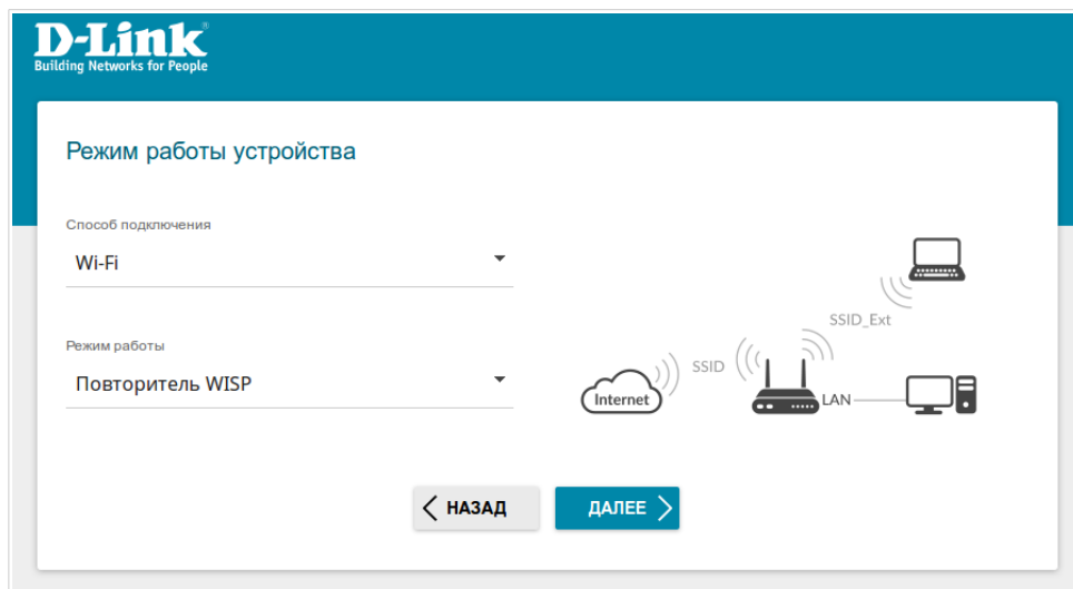
Рисунок 24. Выбор режима работы устройства. Режим Повторитель WISP .
